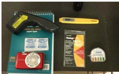
✓ **Matériel d'inspection : lampe de poche, thermomètres, bandes d'analyse, carnet, caméra**
